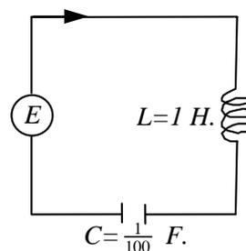
**Ejercicio 6:** Supongamos que inicialmente el condensador está cargado con  $q(0) = 0.1$  culombios y que se deja circular *libremente* una corriente que al principio es de intensidad  $i(0) = 1$  amperio. En este caso, la intensidad del circuito oscila a lo largo del tiempo y viene dada por  $i(t) = \cos(10t) + \sin(10t)$ .
