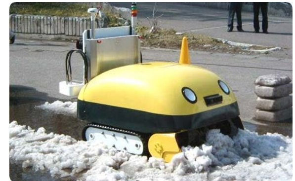
雪の取り込み風景 (除雪ロボット前部)
