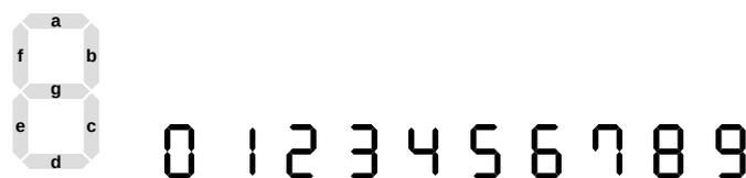
Figura 2.1: Pantalla de 7 segmentos, con su correspondiente iluminación para cada dígito.
