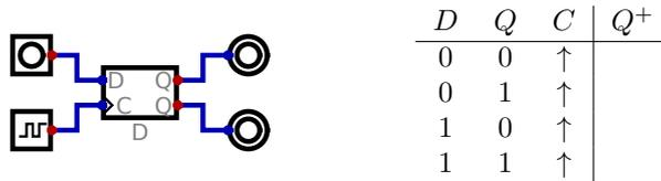
Figura 4.2: Flip-flop D y su tabla de transición.  $Q$  indica el estado/salida antes del flanco ascendente de reloj y  $Q^+$  el estado/salida tras el flanco.
