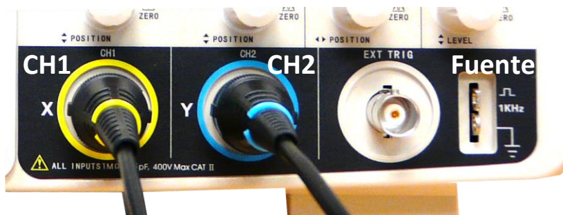
Figura 3.4 Conectores del panel frontal del osciloscopio Siglent SDS1062d con las sondas enchufadas.
