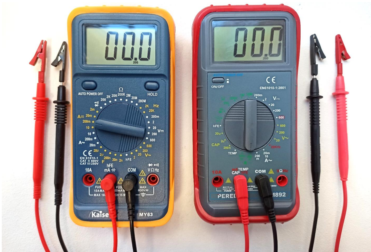
Figura 2: Configuración y conexión de los multímetros Kaise® MY63 y PEREL® EVM 892 como amperímetros para medir corrientes continuas entre 20 y 200 mA utilizando las pinzas de las puntas de prueba.
