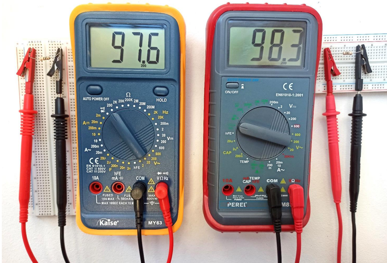
Figura 7: Configuración y conexión de dos multímetros como ohmímetros para medir resistencias de hasta 200\ \Omega (se desconecta la resistencia del circuito y se conecta al ohmímetro utilizando las pinzas de las puntas de prueba).
