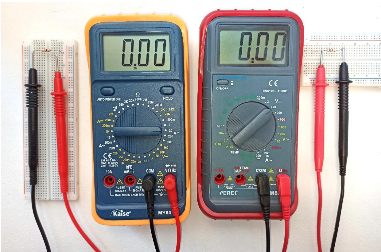
Figura 5: Configuración y conexión de dos multímetros como voltímetros para medir tensiones continuas entre 2 y 20 V tocando con las puntas de prueba sobre dos terminales cuya tensión se quiere conocer.
