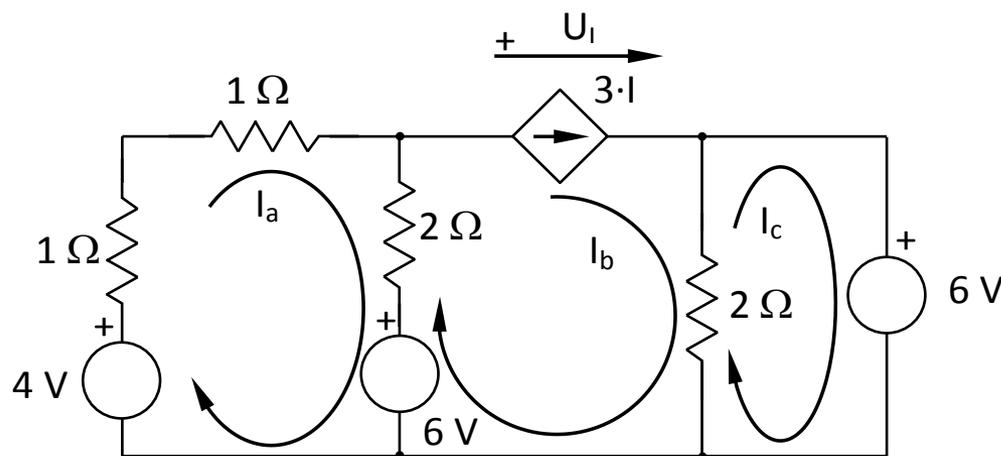
$$\begin{bmatrix} 1+2+1 & -2 & 0 \\ -2 & 2+2 & -2 \\ 0 & -2 & 2 \end{bmatrix} \cdot \begin{bmatrix} I_a \\ I_b \\ I_c \end{bmatrix} = \begin{bmatrix} 4-6 \\ 6-U_i \\ -6 \end{bmatrix}$$
