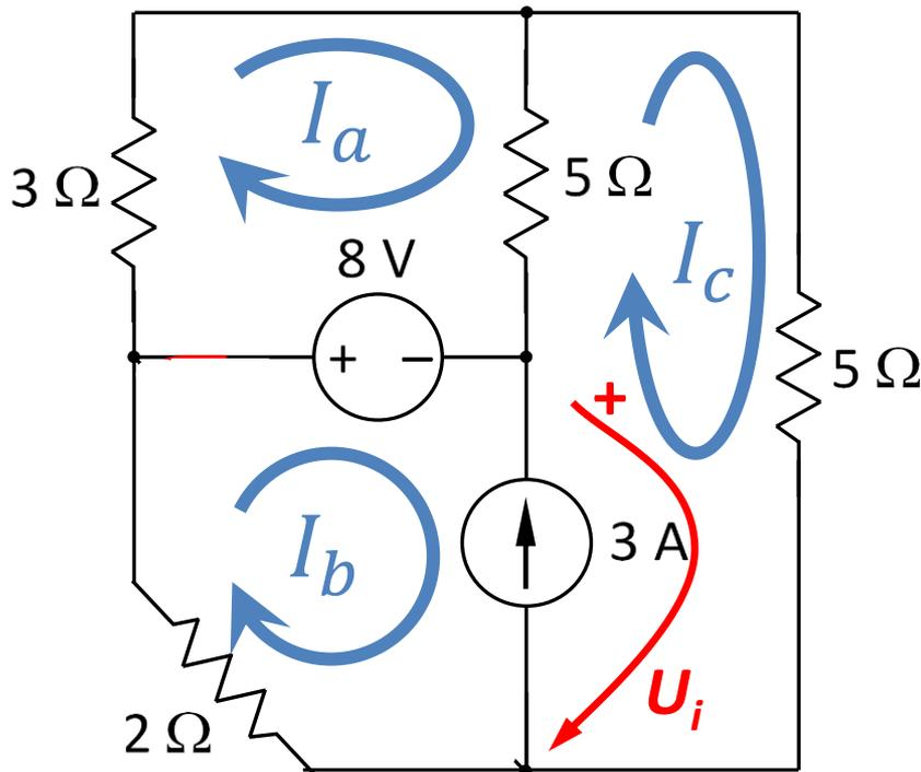
$$\begin{bmatrix} 3+5 & 0 & -5 \\ 0 & 2 & 0 \\ -5 & 0 & 5+5 \end{bmatrix} \cdot \begin{bmatrix} I_a \\ I_b \\ I_c \end{bmatrix} = \begin{bmatrix} +8 \\ -8 - U_i \\ +U_i \end{bmatrix}$$
