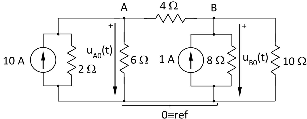
$$\begin{bmatrix} \frac{1}{2} + \frac{1}{6} + \frac{1}{4} & -\frac{1}{4} \\ -\frac{1}{4} & \frac{1}{4} + \frac{1}{8} + \frac{1}{10} \end{bmatrix} \cdot \begin{bmatrix} u_{A0}(t) \\ u_{B0}(t) \end{bmatrix} = \begin{bmatrix} 10 \\ 1 \end{bmatrix}$$
