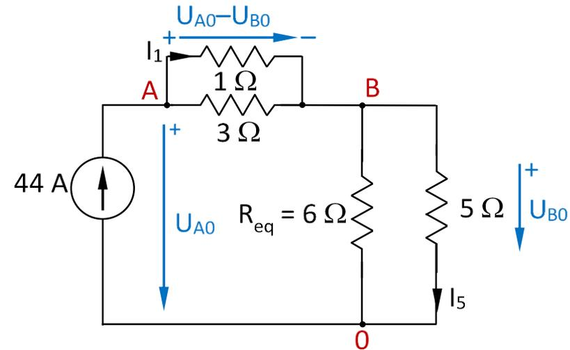
$$\begin{bmatrix} \frac{1}{1} + \frac{1}{3} & -\left(\frac{1}{1} + \frac{1}{3}\right) \\ -\left(\frac{1}{1} + \frac{1}{3}\right) & \frac{1}{1} + \frac{1}{3} + \frac{1}{6} + \frac{1}{5} \end{bmatrix} \begin{bmatrix} U_{A0} \\ U_{B0} \end{bmatrix} = \begin{bmatrix} 44 \\ 0 \end{bmatrix}$$
