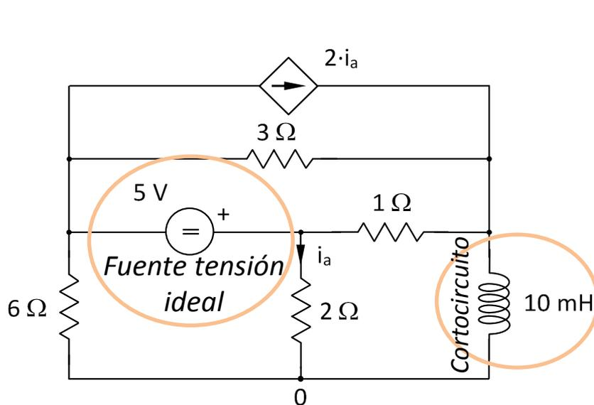
$$\begin{bmatrix} \frac{1}{6} + \frac{1}{3} & -0 \\ -0 & \frac{1}{1} + \frac{1}{2} \end{bmatrix} \cdot \begin{bmatrix} U_{A0} \\ U_{B0} \end{bmatrix} = \begin{bmatrix} -I_e - 2i_a \\ +I_e \end{bmatrix}$$
