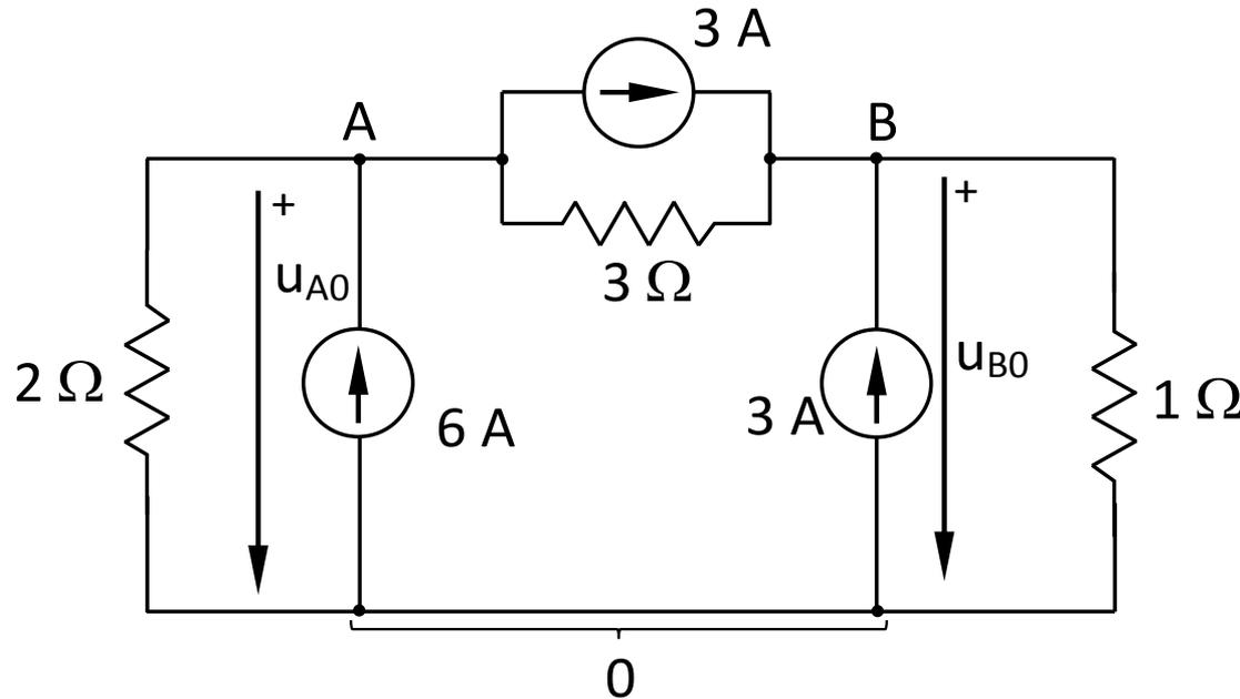
$$\begin{bmatrix} \frac{1}{2} + \frac{1}{3} & -\frac{1}{3} \\ -\frac{1}{3} & \frac{1}{3} + \frac{1}{1} \end{bmatrix} \cdot \begin{bmatrix} u_{A0} \\ u_{B0} \end{bmatrix} = \begin{bmatrix} 6 - 3 \\ 3 + 3 \end{bmatrix}$$
