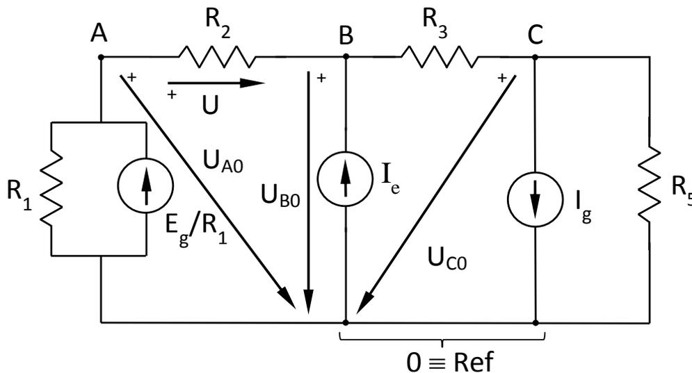
$$\begin{bmatrix} 1+2 & -2 & 0 \\ -2 & 2+3 & -3 \\ 0 & -3 & 3+5 \end{bmatrix} \cdot \begin{bmatrix} U_{A0} \\ U_{B0} \\ U_{C0} \end{bmatrix} = \begin{bmatrix} 8 \\ 13 \\ +46 \end{bmatrix}$$
