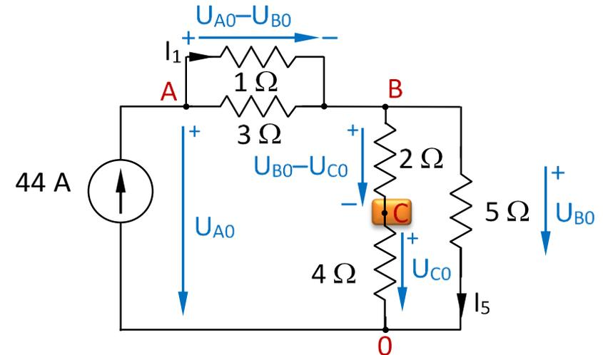
$$\begin{bmatrix} \frac{1}{1} + \frac{1}{3} & -\left(\frac{1}{1} + \frac{1}{3}\right) & 0 \\ -\left(\frac{1}{1} + \frac{1}{3}\right) & \frac{1}{1} + \frac{1}{3} + \frac{1}{2} + \frac{1}{5} & -\frac{1}{2} \\ 0 & -\frac{1}{2} & \frac{1}{2} + \frac{1}{4} \end{bmatrix} \cdot \begin{bmatrix} U_{A0} \\ U_{B0} \\ U_{C0} \end{bmatrix} = \begin{bmatrix} 44 \\ 0 \\ 0 \end{bmatrix}$$
