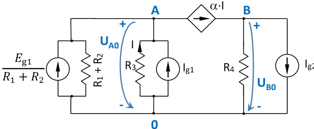
$$\begin{bmatrix} \frac{1}{1+1} + \frac{1}{2} & 0 \\ 0 & \frac{1}{2} \end{bmatrix} \cdot \begin{bmatrix} U_{A0} \\ U_{B0} \end{bmatrix} = \begin{bmatrix} \frac{4}{1+1} + 3 - 3(-U_{A0}/2) \\ 3(-U_{A0}/2) - 12 \end{bmatrix}$$
