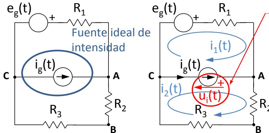
Se dibuja, en sentido arbitrario, la tensión en bornes de la fuente (incógnita)
