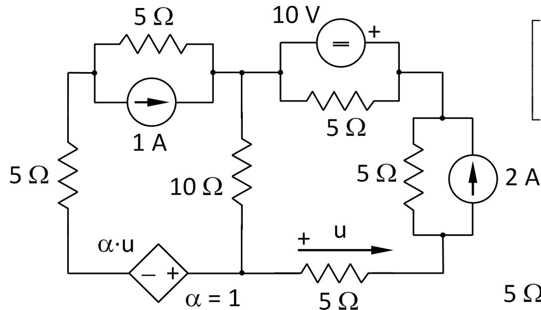
$$\begin{bmatrix} 5+10+5 & -10 & 0 \\ -10 & 5+5+10 & 0 \\ 0 & 0 & 5 \end{bmatrix} \begin{bmatrix} I_a \\ I_b \\ I_c \end{bmatrix} = \begin{bmatrix} 5-u \\ +10-10 \\ -10 \end{bmatrix}$$
