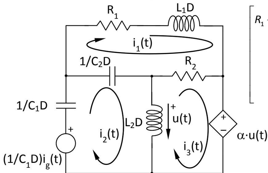
$$\begin{bmatrix} R_1 + L_1D + R_2 + \frac{1}{C_2D} & -\frac{1}{C_2D} & -R_2 \\ -\frac{1}{C_2D} & \frac{1}{C_1D} + \frac{1}{C_2D} + L_2D & -L_2D \\ -R_2 & -L_2D & R_2 + L_2D \end{bmatrix} \cdot \begin{bmatrix} i_1(t) \\ i_2(t) \\ i_3(t) \end{bmatrix} = \begin{bmatrix} 0 \\ \frac{1}{C_1D} i_g(t) \\ -\alpha \cdot u(t) \end{bmatrix}$$
