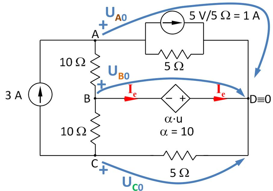
$$\begin{bmatrix} \frac{1}{10} + \frac{1}{5} & -\frac{1}{10} & 0 \\ -\frac{1}{10} & \frac{1}{10} + \frac{1}{10} & -\frac{1}{10} \\ 0 & -\frac{1}{10} & \frac{1}{10} + \frac{1}{5} \end{bmatrix} \cdot \begin{bmatrix} U_{A0} \\ U_{B0} \\ U_{C0} \end{bmatrix} = \begin{bmatrix} 3-1 \\ -I_e \\ -3 \end{bmatrix}$$
