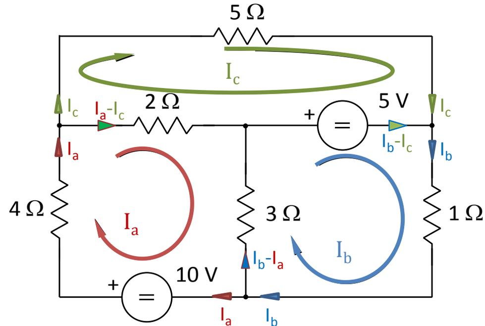
$$\begin{bmatrix} 4+2+3 & -3 & -2 \\ -3 & 3+1 & 0 \\ -2 & 0 & 5+2 \end{bmatrix} \cdot \begin{bmatrix} I_a \\ I_b \\ I_c \end{bmatrix} = \begin{bmatrix} +10 \\ -5 \\ +5 \end{bmatrix}$$
