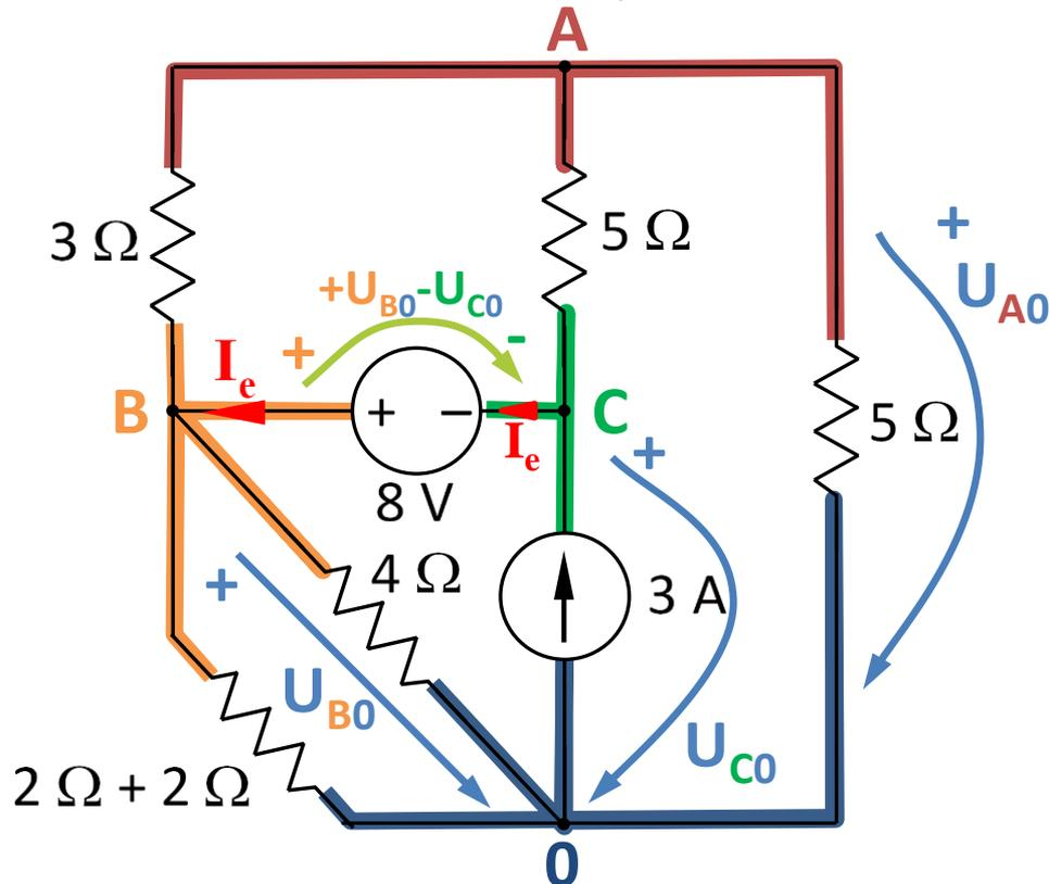
$$\begin{bmatrix} \frac{1}{3} + \frac{1}{5} + \frac{1}{5} & -\frac{1}{3} & -\frac{1}{5} \\ -\frac{1}{3} & \frac{1}{3} + \frac{1}{4} + \frac{1}{2+2} & 0 \\ -\frac{1}{5} & 0 & \frac{1}{5} \end{bmatrix} \begin{bmatrix} U_{A0} \\ U_{B0} \\ U_{C0} \end{bmatrix} = \begin{bmatrix} 0 \\ +I_e \\ -I_e + 3 \end{bmatrix}$$
