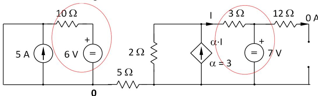
$$\begin{bmatrix} \frac{1}{2} + \frac{1}{3} & -\frac{1}{2} - \frac{1}{3} \\ -\frac{1}{2} - \frac{1}{3} & \frac{1}{2} + \frac{1}{3} + \frac{1}{5} \end{bmatrix} \cdot \begin{bmatrix} U_{A0} \\ U_{B0} \end{bmatrix} = \begin{bmatrix} 3I + \frac{7}{3} \\ -3I - \frac{7}{3} \end{bmatrix}$$
