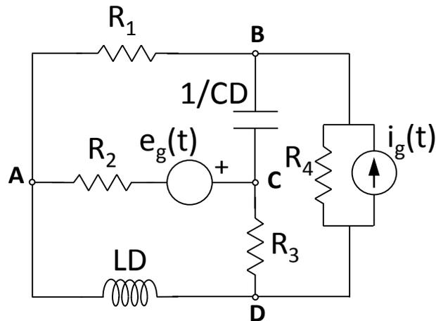
$$\begin{bmatrix} R_1 + \frac{1}{CD} + R_2 & -R_2 & -\frac{1}{CD} \\ -R_2 & R_2 + R_3 + LD & -R_3 \\ -\frac{1}{CD} & -R_3 & R_4 + R_3 + \frac{1}{CD} \end{bmatrix} \cdot \begin{bmatrix} i_1(t) \\ i_2(t) \\ i_3(t) \end{bmatrix} = \begin{bmatrix} -e_g(t) \\ e_g(t) \\ -R_4 i_g(t) \end{bmatrix}$$
