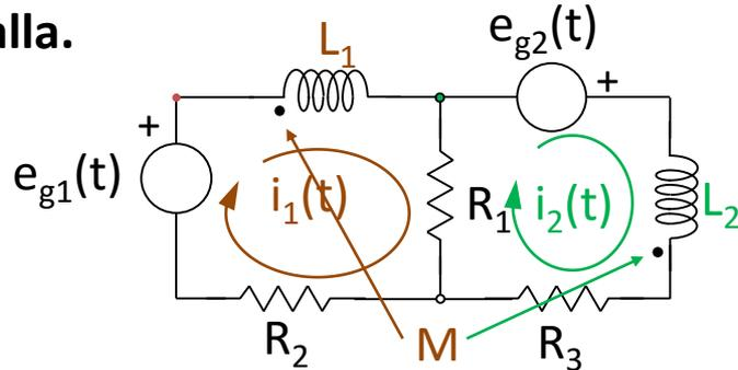
2) Razonar con los terminales • marcados para obtener el sentido de la tensión que las corrientes de malla inducen (debido al acoplamiento magnético mutuo) en la otra bobina.
