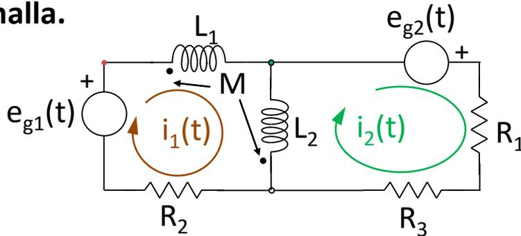
2) Razonar con los terminales  $\bullet$  marcados para obtener el sentido de las tensiones debido al acoplamiento magnético mutuo
