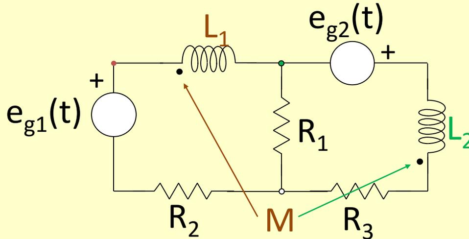
Para ayudarnos a escribir las ecuaciones de malla, dibujamos las referencias  $\rightarrow$  de la tensión inducida por su acoplamiento magnético mutuo en la otra bobina.
