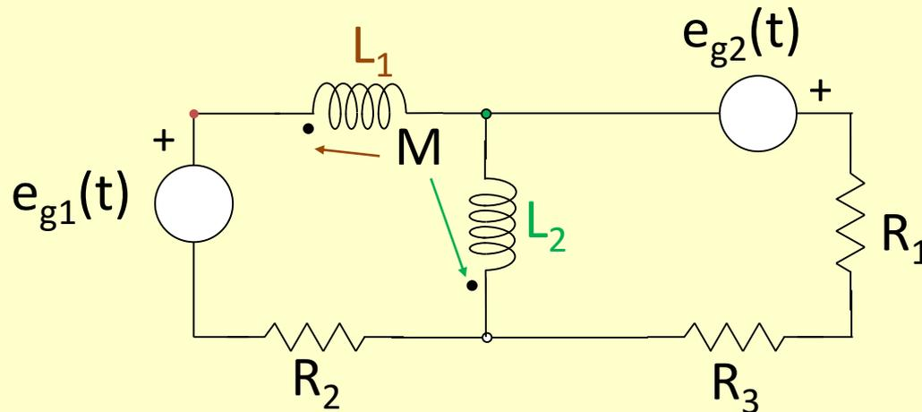
Para ayudarnos a escribir las ecuaciones de malla, dibujamos las referencias  $\rightarrow$  de la tensión inducida por su acoplamiento magnético mutuo en la otra bobina.
