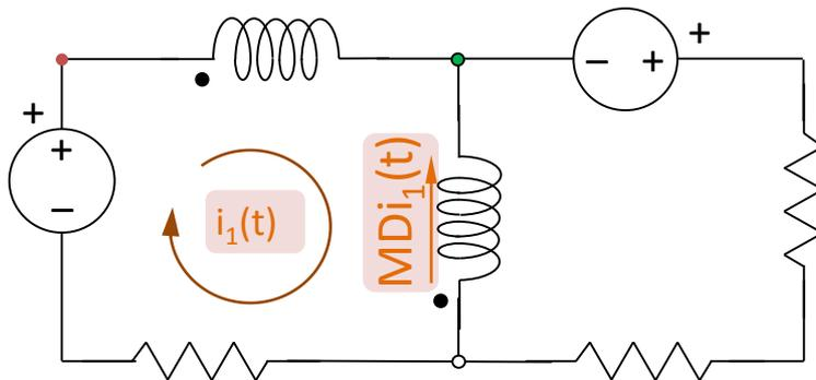
2b) Marcar la referencia de las tensiones  $MD i_2(t)$  y  $MD i_1(t)$  en bobina izquierda debida a la otra bobina
