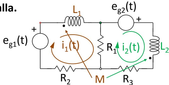
2) Razonar con los terminales • marcados para obtener el sentido de las tensiones mutuas debido al acoplamiento magnético
