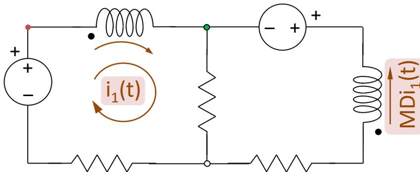
**2b) Marcar la referencia de la tensión Mutua  $M D i_2(t)$  en la bobina izquierda en el sentido de circulación de la otra bobina**
