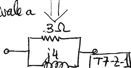
Ejemplo SERIE: Calcule la potencia compleja que absorbe una resistencia  $R = 3 \Omega$  conectada en serie con una impedancia  $jX = j4 \Omega$  cuando es alimentada por una fuente sinusoidal (de "corriente alterna") de tensión eficaz 10 V. Tomar la fuente de tensión como origen de fases de los fasores.
