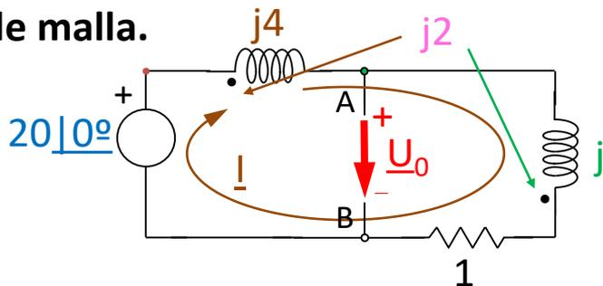
2) Razonar con los terminales • marcados para obtener el sentido de la tensión que las corrientes de malla inducen (debido al acoplamiento magnético) en la otra bobina.
