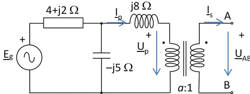
En el transformador no circula corriente  $\rightarrow$  no cae tensión en  $j8 \Omega \rightarrow U_p$  coincide con la tensión en el condensador  $-j5 \Omega$ , que se puede calcular por divisor de tensión entre  $-j5 \Omega$  y  $4+j2 \Omega$ :
