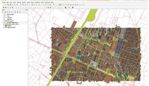
El proceso se repite con la capa de agua y carreteras para completar la información que sirve como referencia especial para el proyecto.
