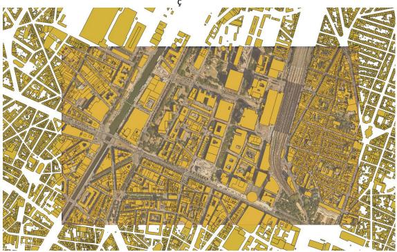
Primero, seleccionamos la capa de edificios en el panel de capas y después usaremos la herramienta de selección por rectángulo para dibujar un área que cubre la imagen entera de Google Earth.
