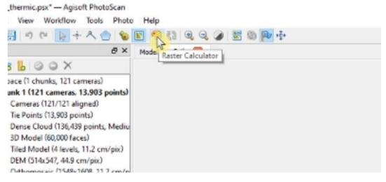
Además, para las imágenes térmicas es importante crear un índice térmico que genera una ortofoto en la que el pixel, en vez de un valor RGB presenta un dato numérico de la temperatura, el dato radiométrico. Cuando activas la herramienta del raster calculator deberás introducir la siguiente fórmula en la línea de expresión:
