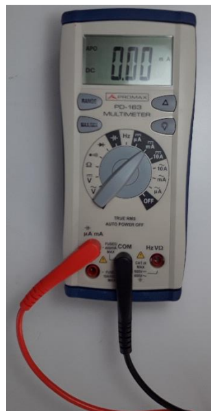
Multímetro configurado para medir corriente
