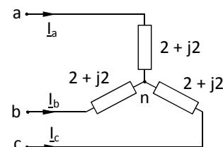
**Problema 1:** Dado el circuito de la figura, determinar, aplicando el **método de análisis por nudos** y tomando el nudo 0 como nudo de referencia:
