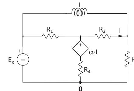
**Problema 2:** Para el dipolo de la figura, determinar el equivalente Thévenin y el equivalente Norton vistos desde sus terminales A y B, y comprobar los resultados. (3 puntos)
