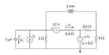
Problema 2: Dado el dipolo activo de la figura, determinar su equivalente Norton visto desde los terminales A y B y dibujarlo. ¿Cuál es la máxima potencia activa que se puede extraer de este dipolo?
