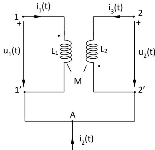
Para las referencias indicadas en la figura, y los terminales correspondientes determinados anteriormente, las ecuaciones de definición de estas dos bobinas acopladas son:
