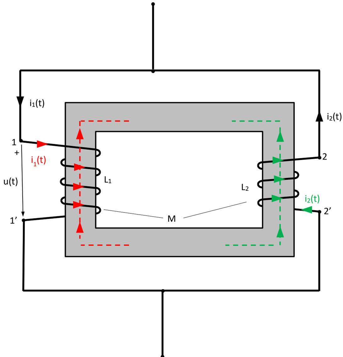
Si la intensidad  $i_1(t)$  entra por el terminal 1 de la bobina 1, crea una línea de campo magnético con sentido horario (regla de la mano derecha). Si la intensidad  $i_2(t)$  entra por el terminal 2' de la bobina 2, crea una línea de campo magnético con sentido antihorario. Por lo tanto, al tener las líneas de campo creadas por esas dos intensidades entrando por los terminales 1 y 2' distintos sentidos, se deduce que los terminales 1 y 2' NO SON CORRESPONDIENTES, Así pues,
