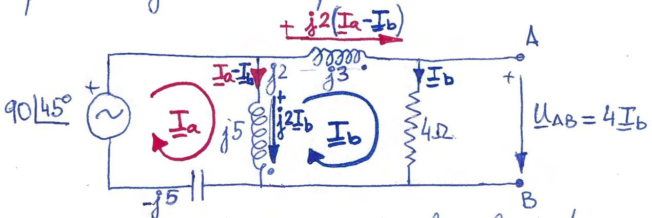
Para mayor claridad, las tensiones debidas al acoplamiento magnético se han marcado en el circuito superior.
