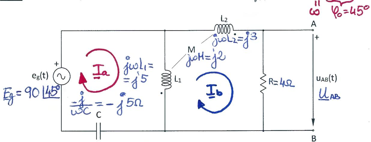
La única fuente independiente pulsa a  $\omega = 50 \text{ rad/s}$ , por lo que el dipolo se analizará en RES a  $\omega = 50 \text{ rad/s}$  por el método simbólico (representando las ondas de corriente y tensión mediante fasores).
