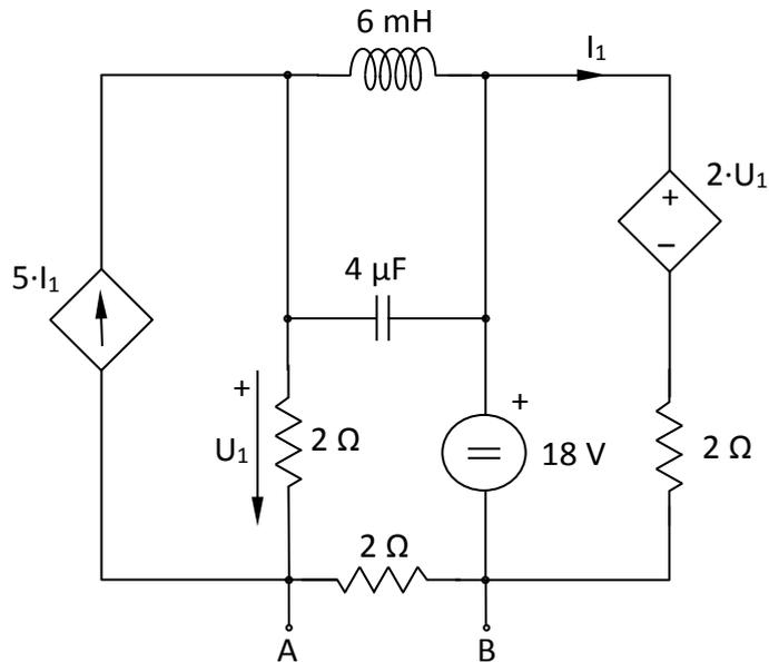
a) Dibujar el dipolo cortocircuitado y transformado para aplicarle el método de **análisis por mallas**. Indicar sobre este dibujo las referencias de la corriente de cortocircuito y las corrientes de circulación consideradas, así como el resto de referencias necesarias.
